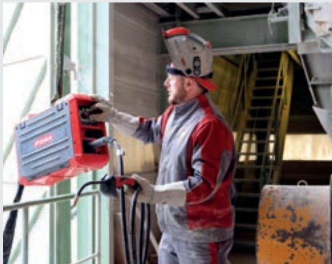
/ Ein ergonomisch konstruierter Haltegriff sorgt für einen sicheren Transport – per Hand oder mit Seil am Kran
